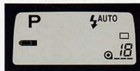
Wenn Sie den Hauptschalter in Position „ON“ bringen, prüft die Kamera automatisch den Batteriezustand.
