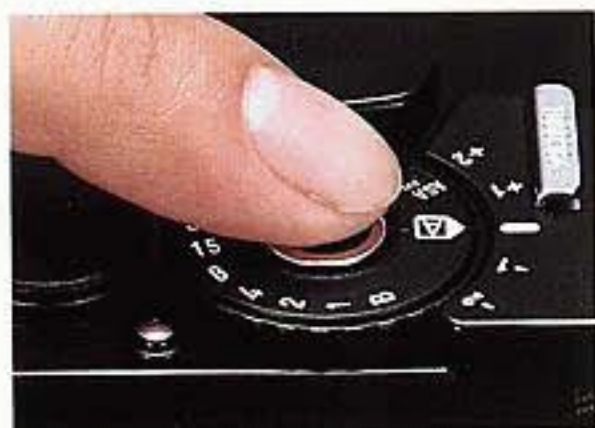
»Touch-switch«-Meßschalter Minolta's stromsparender »Berührungsschalter« aktiviert die CLE-Elektronik auf leichtesten Fingerkontakt. Mit Handschuhen genügt leichtes Andrücken des Auslösers um 0,4 mm zum Einschalten des Meßsystems.
