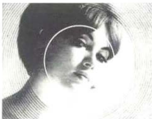
Mikroprismenraster flimmerfrei = scharf
