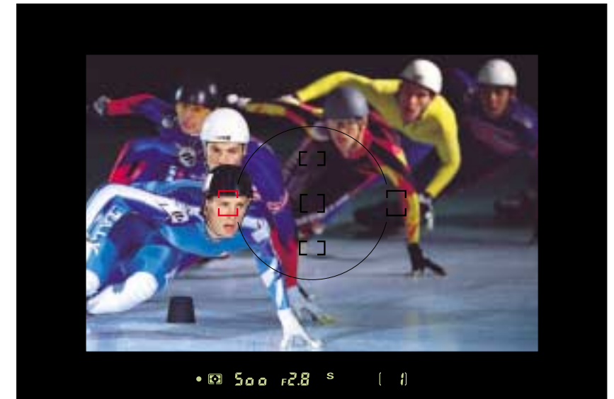
Das gewählte AF-Meßfeld wird auf der Einstellscheibe hervorgehoben. Die Stärke der Hervorhebung variiert je nach Allgemeinheitigkeit
