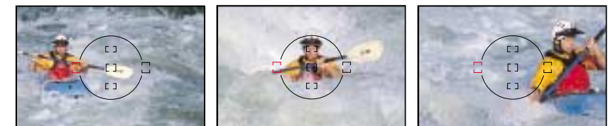
AF-Dynamik: Wenn das Objekt das Primärfeld verläßt, übernimmt das nächstgelegene AF-Meßfeld und hält die Scharfeinstellung aufrecht.
