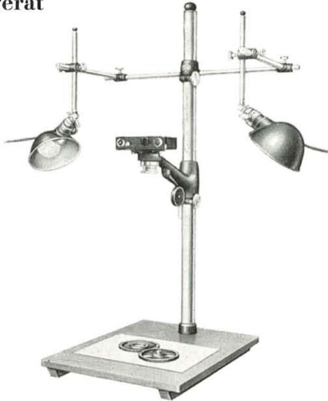
Reproduktion mit Beleuchtungseinrichtung
