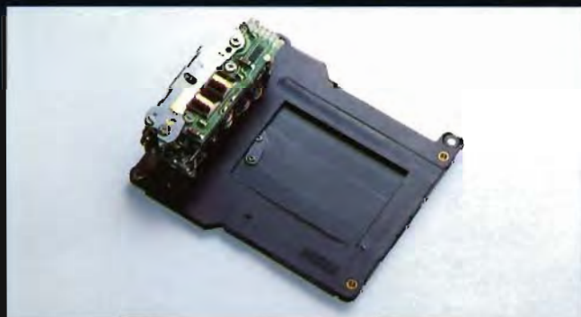
Der quartzgesteuerte High-Tech-Metall-Lamellen-Schlitzverschluß von Copal erlaubt extrem kurze Belichtungszeiten von 1/8000 s bei Dauerlicht und 1/250 s bei der Elektronenblitz-Synchronisation. Bei 1/8000 s ist der Schlitz nur 1 mm breit
