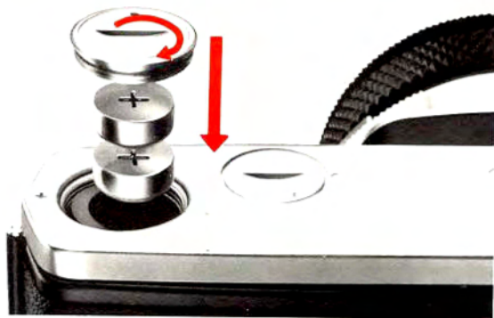
Zwei 1,5 V Silberoxid-Batterien einsetzen; auf richtige Polung achten.
