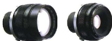
1 Zeiko MC Auto-Macro-Objektivkopf 4,5/135 mm. Direktanschluß mit OM-Bajonett: Am Macrotubus von  $\infty$  bis 1:2,5. Am Balgengerät bis max. 1:1. Mit Blendenautomatik und Feinscharfstellung.
