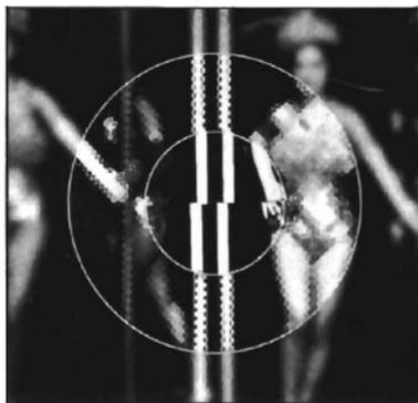
Die Standardeinstellscheibe der MX besitzt als Fokussierhilfe im Zentrum eine Kombination von Mikroprismen und einem Schnittbildindikator. Bei unscharfer Einstellung wird eine Linie durch den Schnittbildindikator unterbrochen und seitlich versetzt. Drehen Sie nun solange, bis sich beide Linien decken.
