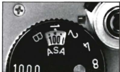
Die ASA-Filmempfindlichkeit ist auf jeder Filmpackung angegeben. Je höher die ASA-Zahl, umso lichtempfindlicher ist das Filmmaterial. Drücken Sie den ASA-Sicherungsstift **A** ein und drehen Sie den ASA-Ring **B** soweit, bis die gewünschte Zahl gegenüber der Markierung steht. Da die Einstellung der Filmempfindlichkeit mit dem Belichtungsmesser gekuppelt ist, kann bei falsch eingestellter ASA-Zahl ein falscher Meßwert erzielt werden.
