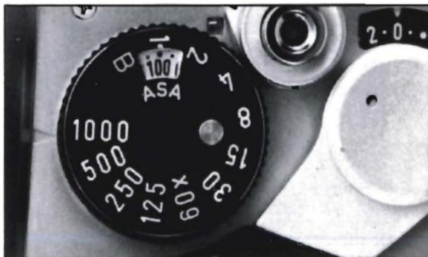
Die beiden Batterien der MX dienen nur als Stromversorgung für den Belichtungsmesser. Die Verschlußsteuerung erfolgt auf mechanischer Basis durch ein Räderhemmwerk. Daher bleibt Ihre Camera auch ohne Batterien funktionsfähig. Sie können sich in einem solchen Falle nach den Belichtungsanhaltswerten des Filmdatenblattes richten und eine entsprechende Zeit-Blenden-Kombination wählen.
