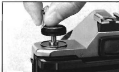
1. Der Rückspulknopf wird soweit hochgezogen, bis die Rückwand aufspringt.
