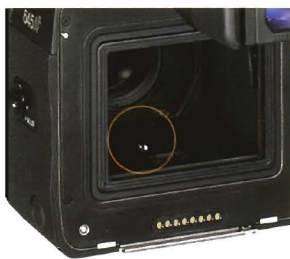
TTL Messzelle im Spiegelkasten
