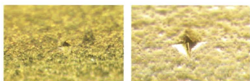
Vergleich der Oberflächenhärte einer Andruckplatte aus Feinkeramik (links) und einer solchen aus Aluminium (rechts) nach dem Aufschlag einer Diamantpyramide mit einer Kraft von 1 kg (200fache Vergrößerung)
