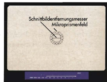
Der Spotmeßbereich deckt sich in etwa mit dem Mikroprismenring
