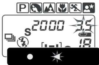
Wenn die Blendenanzeige im Datenmonitor und im Sucher blinkt, liegt die gewählte Verschlusszeit außerhalb des Blendenbereichs des Objektivs. Der Belichtungsindikator im Sucher blinkt, um eine Unterbelichtung (<) oder Überbelichtung (>) anzuzeigen. Wählen Sie eine andere Verschlusszeit, bis das Blinken aufhört.
