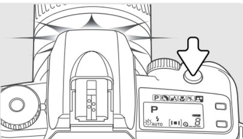
Drücken Sie den Auslöser ganz durch, um den Selbstausröserlauf zu starten. Die Selbstausröseranzeige im Datenfeld blinkt und kurz bevor die Kamera auslöst werden vier Blitze gezündet.
