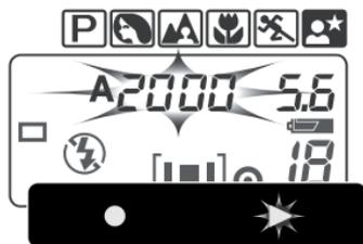
Blinkt im Datenmonitor die Verschlusszeit, liegt die Kamera mit der gewählten Blendeneinstellung außerhalb des Verschlusszeitenbereichs. Die Indikatoren im Sucher blinken bei einer Unterbelichtung (<) oder Überbelichtung (>). Wählen Sie eine andere Blende, bis das Blinken aufhört.
