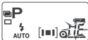
Im Datenmonitor blinkt ME um anzuzeigen, dass die nächste Aufnahme die letzte der Bildserie ist. Drücken Sie den Auslöser für die zweite Aufnahme ganz durch. Der Film wird danach weitertransportiert. Nach der letzten Aufnahme wird die Funktion verlassen.
