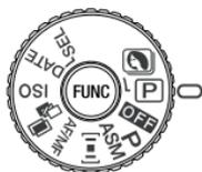
Die Vollautomatik ist das Allround-Belichtungsprogramm der Kamera für schnelles und unkompliziertes Fotografieren. Wenn die Position des Funktionsrades verändert wird, werden folgende Einstellungen zurückgesetzt:
