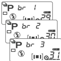
Nach Änderung der Filmtransportfunktion (S. 32) auf Einzelbildbetrieb, Selbstausslösung oder Fernsteuerung drücken Sie den Auslöser für jede der drei Aufnahmen in der Belichtungsreihe erneut; die Selbstausslöserfunktion wird nach jeder Aufnahme zurückgesetzt. Im Datenmonitor wird jeweils die nächste Aufnahme der Serie angezeigt.
