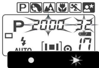
Liegt die Helligkeit außerhalb des Bereichs der verfügbaren Verschlusszeiten und Blenden, blinken die entsprechenden Anzeigen im Datenmonitor. Der Belichtungsindikator im Sucher blinkt, um eine Unterbelichtung (<) oder Überbelichtung (>) anzuzeigen.
