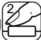
Bei leicht angedrücktem Auslöser (2) wird die entsprechende Verschlusszeit angezeigt. Drücken Sie den Auslöser für die Aufnahme ganz durch.
