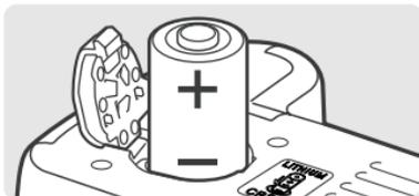
Batterien entsprechend der Markierung auf der Innenseite des Batteriekammerdeckels einlegen. Batterien entsprechend der Plus-/Minus-Markierung einsetzen.
