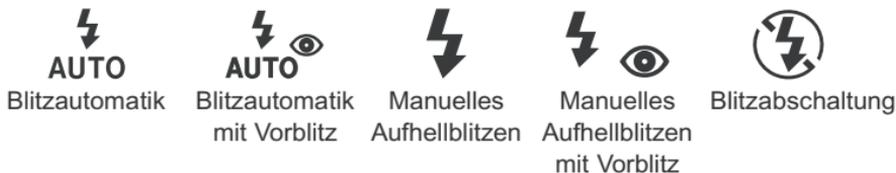
**Blitzautomatik** - Bei Bedarf klappt das eingebaute Blitzgerät automatisch auf (nur im Vollautomatik-Betrieb, in Programmautomatik und bei Wahl eines Motivprogramms (S. 26)).
